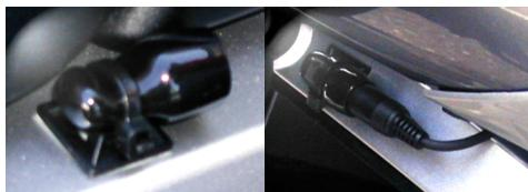
Un conector de goma y soportes están incluidos para extender y proteger la extensión de cable cuando no se usa. La tapa de goma se puede fijar a la moto tal y como se muestra en las fotografías. Esto provee de una instalación resistente a las inclemencias meteorológicas.
